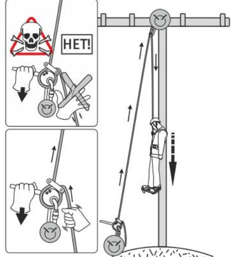
Комплект эвакуационного оборудования предназначен для спасения или эвакуации людей в случае аварии или несчастного случая при производстве работ на высоте. Применяется работником самостоятельно или для спасения пострадавшего при помощи членов рабочей бригады или силами спасательных формирований.
